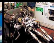
Зона испытания основных насосов гидросистемы
