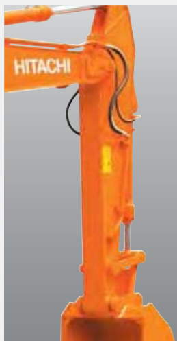
Основные трубопроводы рабочего оборудования
