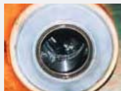
Термическое напыление WC (карбид вольфрама)
