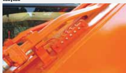
Точки централизованного смазывания шарниров стрелы и рукояти
