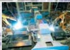
Линия сварки основной рамы
