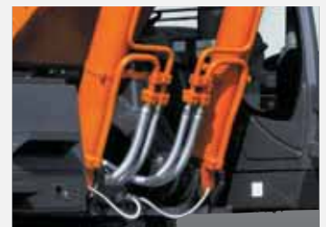
Защита шлангов гидроцилиндров стрелы
