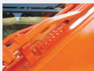
Точки централизованного смазывания шарниров стрелы и рукояти
