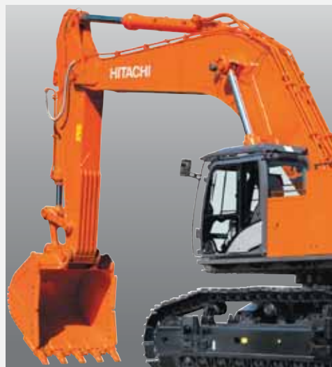
Усиленные стрела и рукоять со скальным ковшом (ZX870H-56 / ZX870LCH-56)
