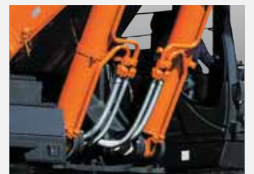
Защита шлангов гидроцилиндров стрелы
