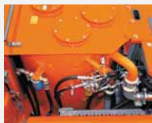
Фильтры на стенке центрального прохода
