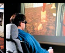
Испытание, имитирующее нахождение на сиденье оператора
